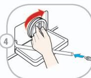
4 Une fois le nettoyage terminé, remettez le filtre en place en le revisant.
