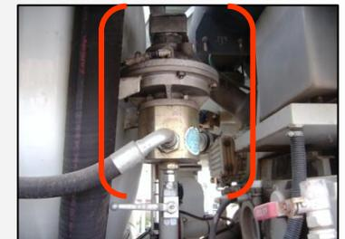
**un manodétendeur (situé à l'arrière du camion) permet de sélectionner la pression désirée en sortie de pompe**
