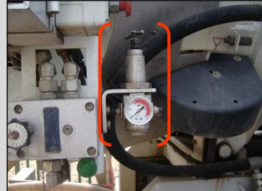
**la pression d'eau obtenue s'affiche en bar sur un manomètre**
