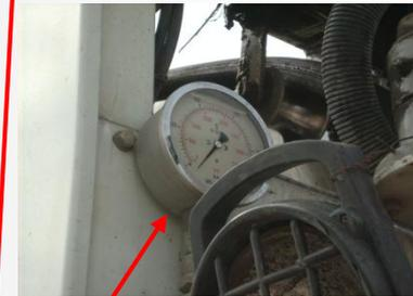
7) Envoyer l'eau propre sous pression en mettant la pompe HP en route
