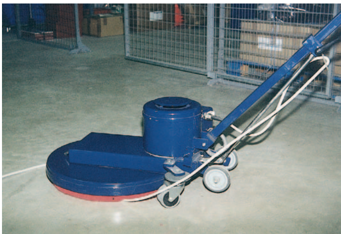
22. Fils passant sous une monobosse : danger
