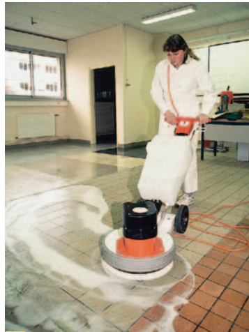
25. Fil électrique sur l'épaule : sécurité
